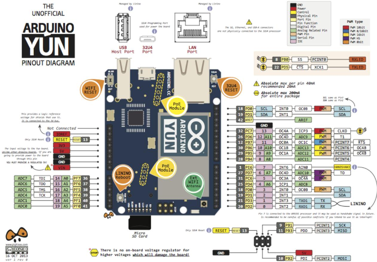
La comunicazione tra la parte Linux e la parte Arduino avviene tramite il bus seriale situato sui pin 0(RX) e 1(TX). Questo bus viene usato per inviare comandi alla parte Linux.
